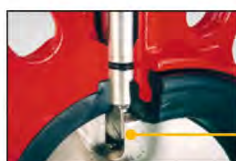
Соединение вала с диском с помощью четырехгранника
