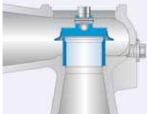
Диск с уплотнительной пластиной J68: Открытый кожух J78: Закрытый кожух
