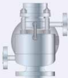
Отопительная рубашка H29, H30: Муфты G 3/8, G 3/4 H31, H32: Фланец Dy15, Dy25
